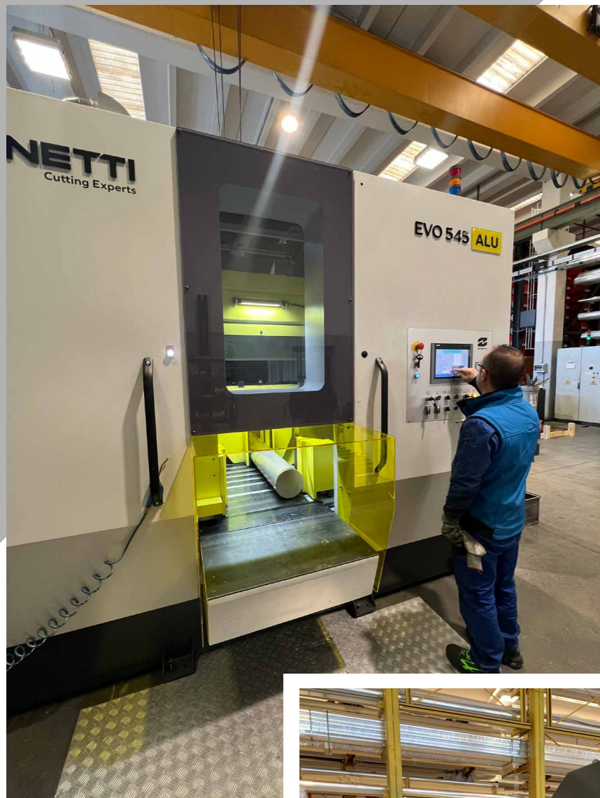
Segatrici a nastro ad alta velocità per taglio barre fino a dia. 550mm
