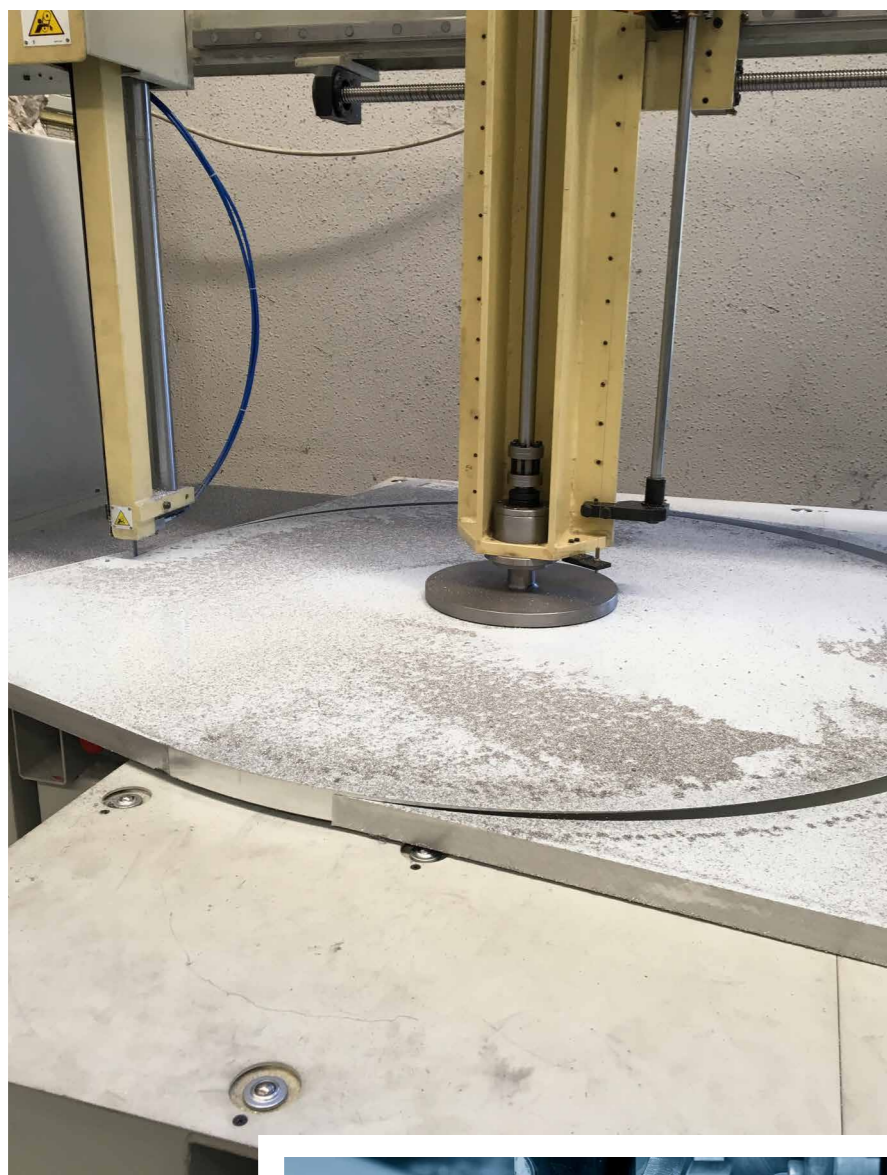
Macchina per taglio dischi formato max dia 2000 mm x h 300 mm
