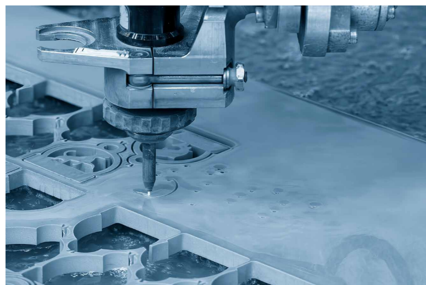
Macchina per taglio "waterjet" formato max mm 2000x4000
