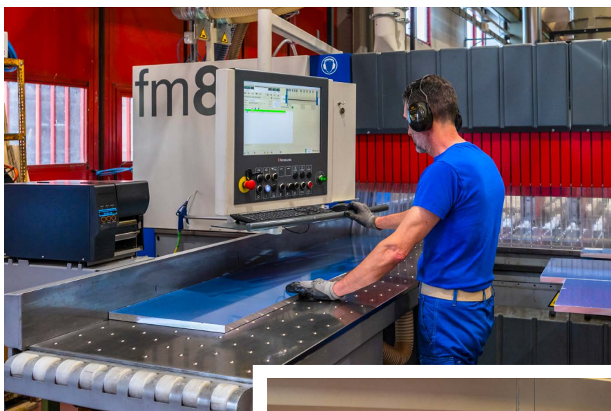
Segatrice a disco ad alta velocità per taglio piastre fino a spessore 150mm
